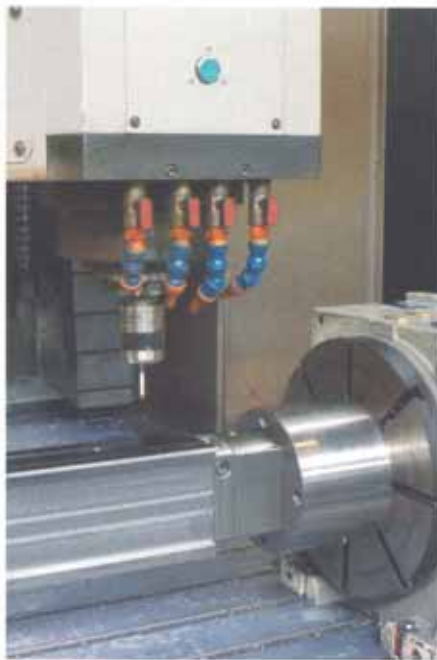
Foto de detalle de utillaje, cabezal, sobre máquina Ibarria
