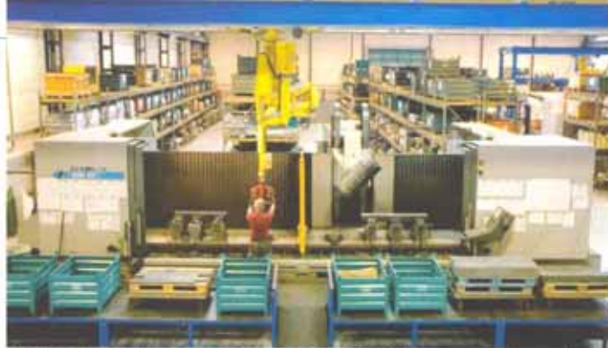
Centro de mecanizado Ibarria mod. ZVH 58/L6000 con cabezal con giro automático continuo, en ejecución de trabajo pendular con carga mediante manipulador ingravido cartesiano
